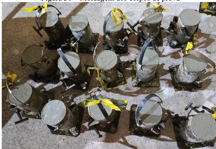
Figura 50 – Moldagem dos corpos de prova
