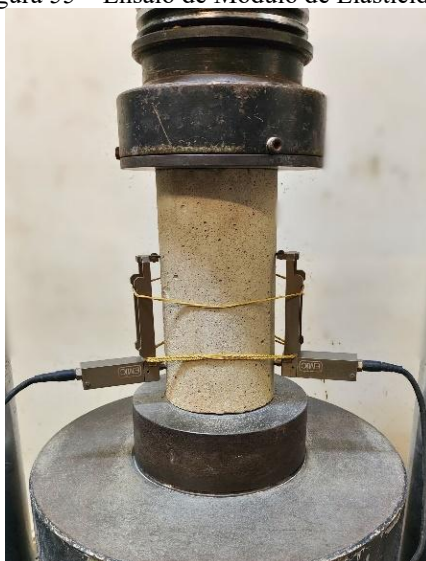
Figura 55 – Ensaio de Módulo de Elasticidade
