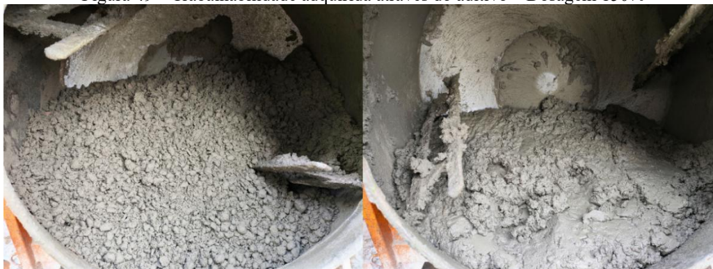
Figura 49 – Trabalhabilidade adquirida através do aditivo – Dosagem 150%
