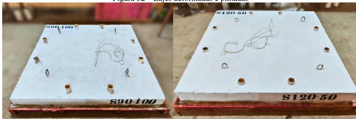
Figura 52 – Lajes deformadas e pintadas
