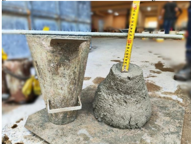
Figura 48 – Abatimento do Tronco de Cone – Dosagem Teor 150%
