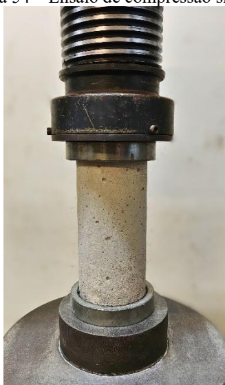
Figura 54 – Ensaio de compressão simples
